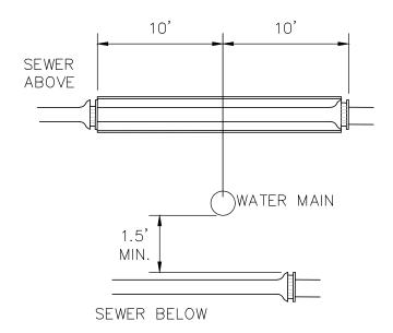
THE SEWER JOINTS SHOULD BE EQUIDISTANCE AND LOCATED AS FAR AWAY AS POSSIBLE FROM THE WATER MAIN JOINTS
